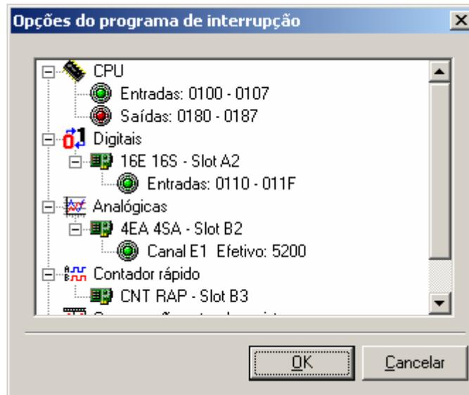
Fig. 61. - Exemplo de configuração de Int1
