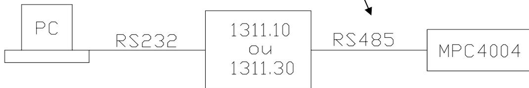
Fig. 99. - Ligando o **MPC4004** a um PC através da **RS485**
